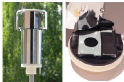
FIGURE 4 : ILLUSTRATION DU CAPTEUR PASSIF DE PARTICULES PM10
