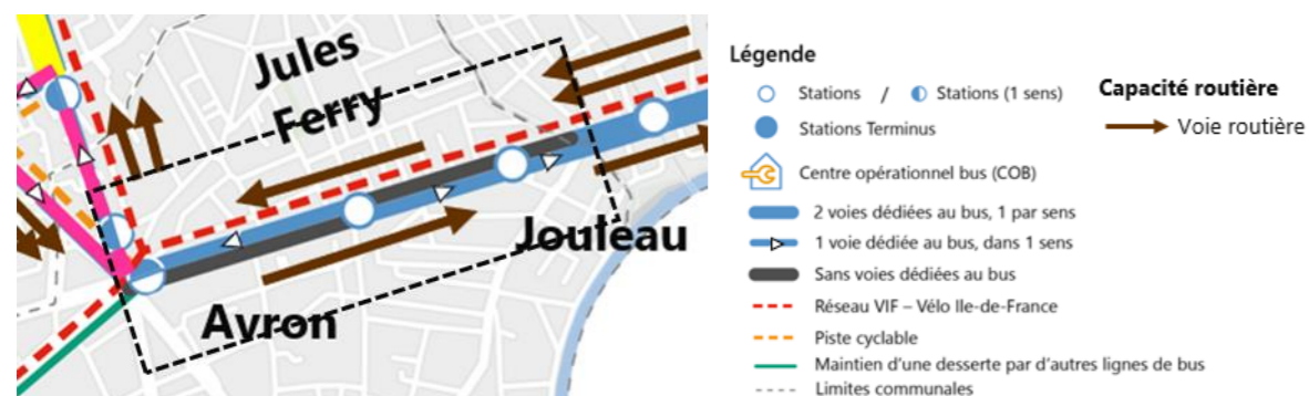
Figure 232 - Principe de couloir unidirectionnel à sens alterné sur l'axe du boulevard Alsace-Lorraine
