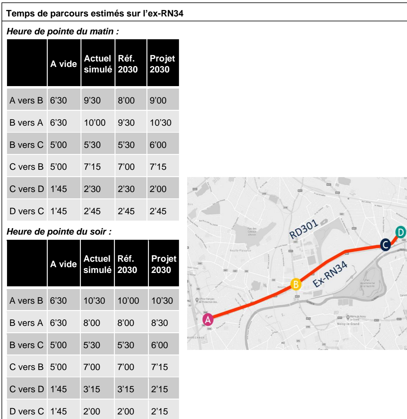
Figure 286 - Temps de parcours moyen en voiture (en minutes) le long de l'ex-RN34 entre deux points - Référence et projet Horizon 2030 (Source : Etude de trafic BBM, AIMSUM, 2023)
