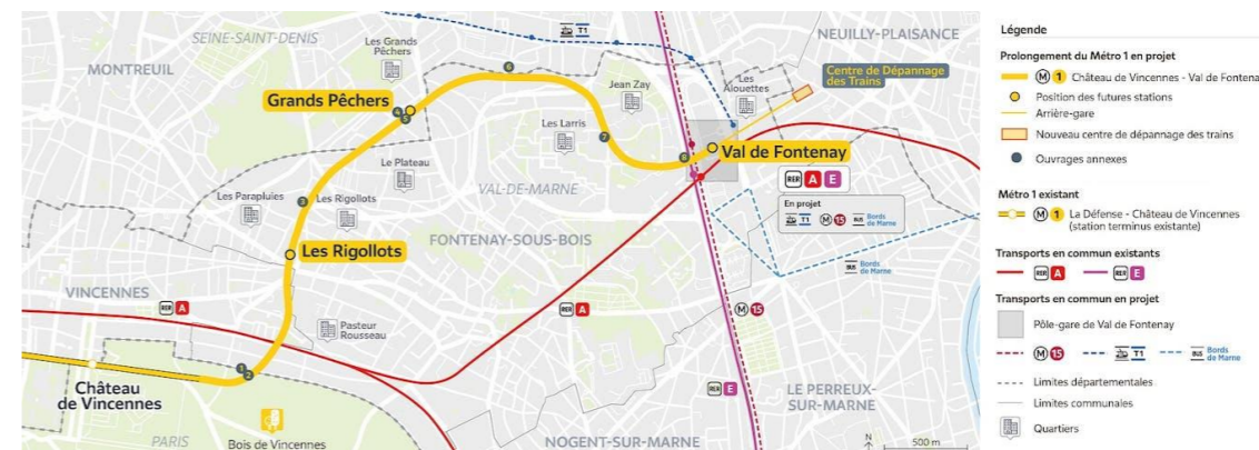
Figure 71 - Tracé du prolongement de la ligne 1 du métro à Val de Fontenay (Source : Ile-de-France Mobilités)
