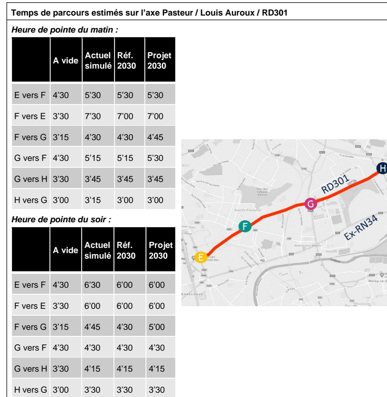
Figure 287 - Temps de parcours moyen en voiture (en minutes) le long de l'axe Pasteur / Louis Auroux / RD301 entre deux points - Référence et projet Horizon 2030 (Source : Etude de trafic BBM, AIMSUM, 2023)
