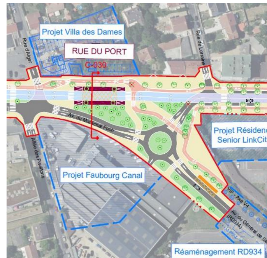
Figure 256 – Aménagement du carrefour « Foch x De Gaulle » - Variante 2 Giratoire avec gestion par feux adaptatifs
