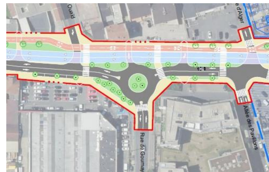
Figure 250 - Aménagement du carrefour « Foch x Rue de Gournay (RD226) » - Variante 2 Giratoire avec gestion par feux adaptatifs
