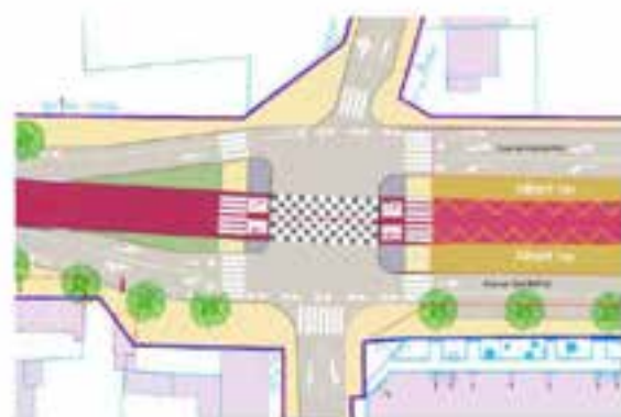
Exemple de carrefour avec sas vélo (RD392)
