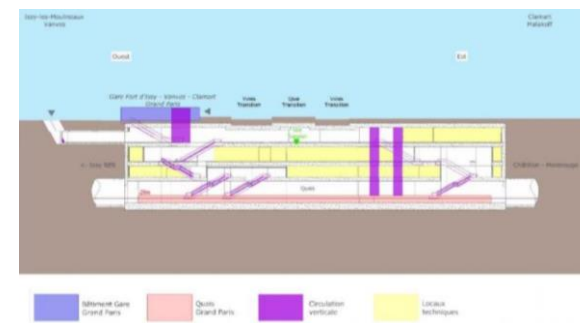
Figure 58 : Coupe de principe de la station Clamart (source : SGP)
