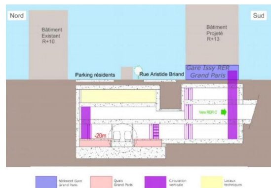
Figure 60 : Coupe de principe de la station Issy (source : SGP)
