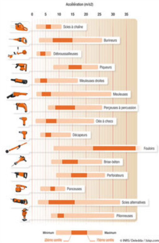
Figure 239 : Exemples de niveaux d'émissions de vibrations par les véhicules et le matériel de chantier.
