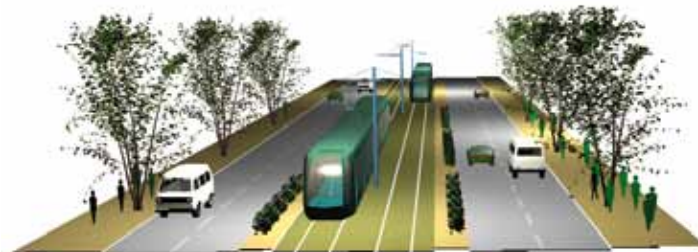
Figure 34 : Vue d'un site propre axial – Source : SYSTRA
