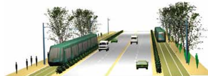
Figure 36 : Vue d'un site propre bilatéral – Source : SYSTRA
