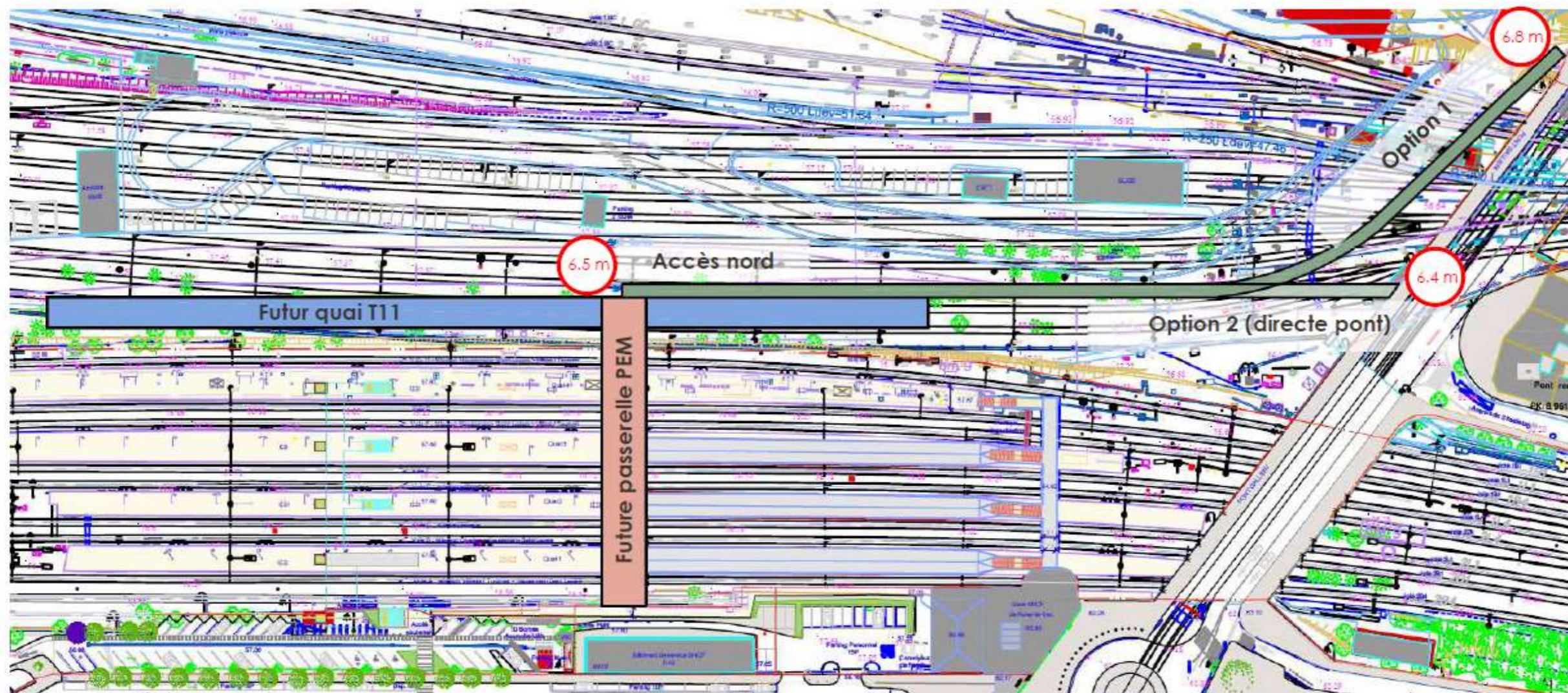
Plan de masse – tracés passerelle d'accès nord
