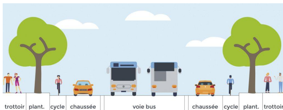
Principe général d'aménagement des voies de bus
