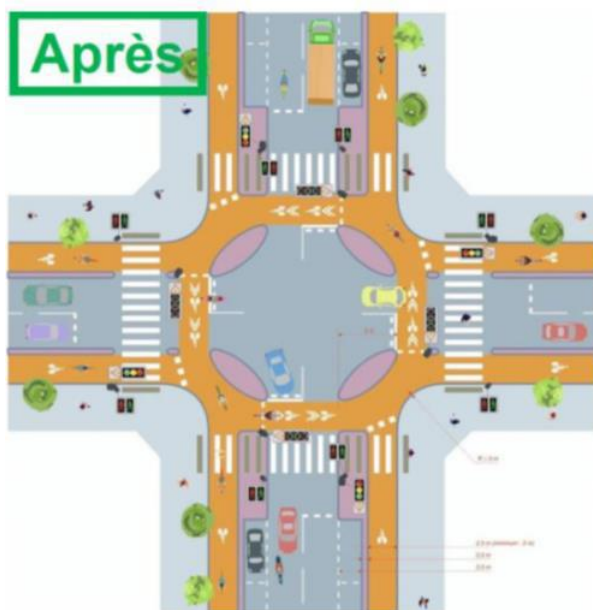
Figure 25 : Carrefour à feux à ilots-amandes (intersection majeure)
