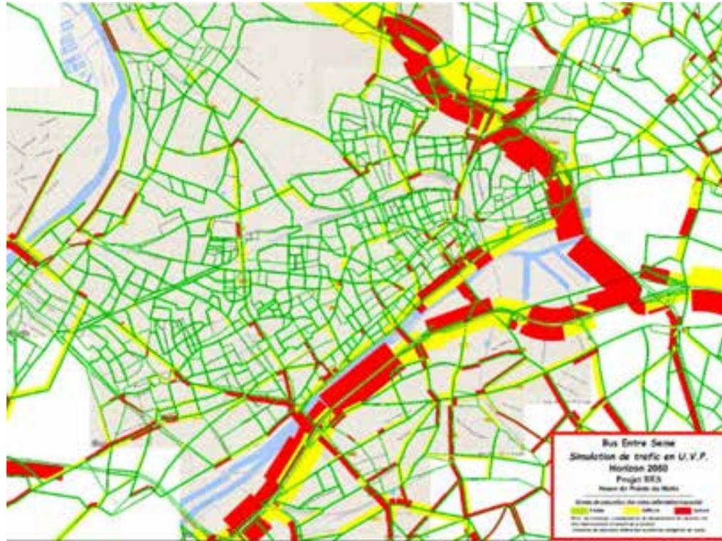
Figure 66 : Niveau de saturation des voies en HPM à l'horizon 2050 (source : CDVIA)
