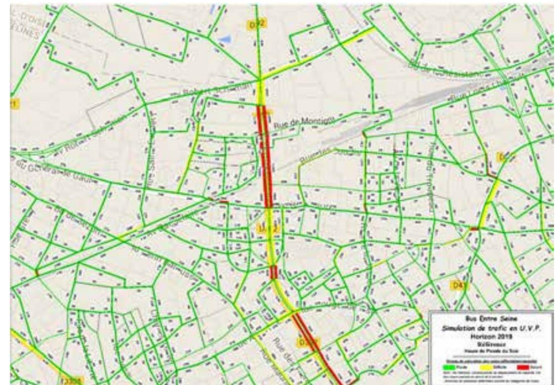
Figure 56 : Niveau de saturation des voies en heure de pointe sur la RD392 (source : CDVIA)
