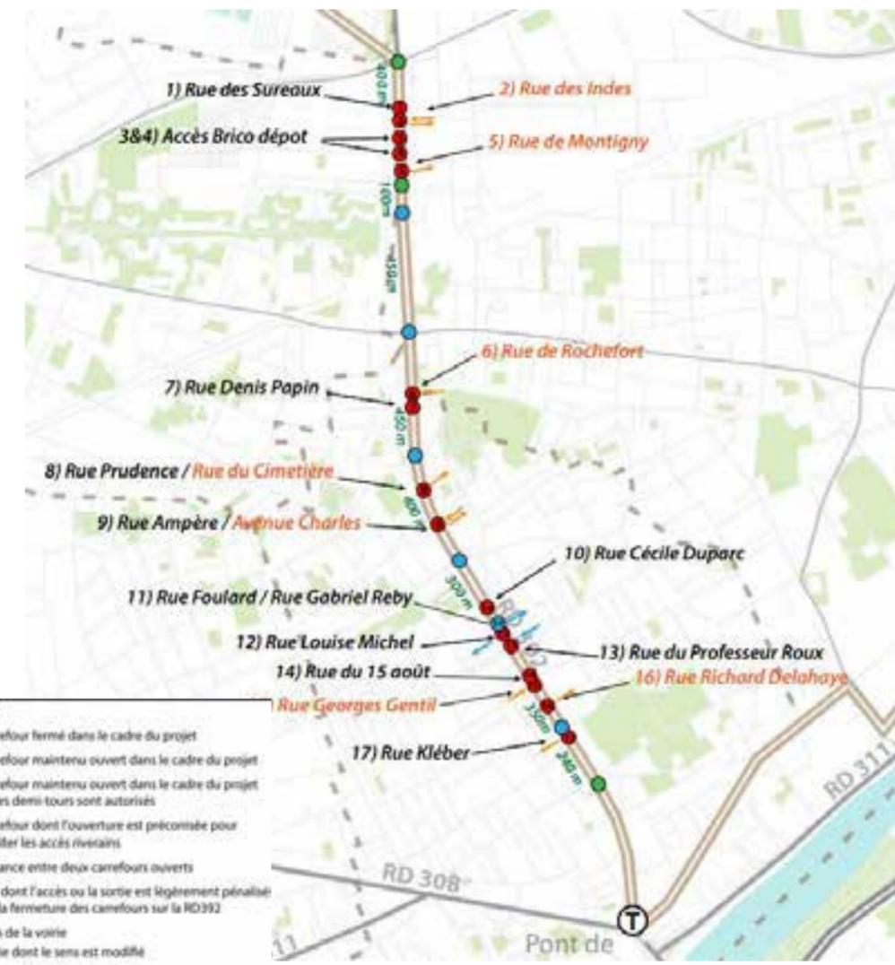
Figure 54 : Synthèse du fonctionnement des carrefours sur la RD392
