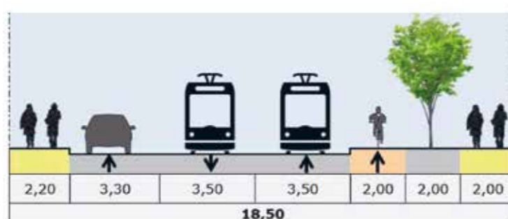
À partir de 18,5 mètres de largeur de rue, le tramway peut être inséré en plateforme bidirectionnelle avec une voie de circulation routière
