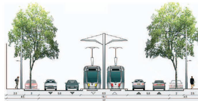
25 – Coupe type de la RN7 entre les stations Athis-Mons Centre commercial et Pyramide
