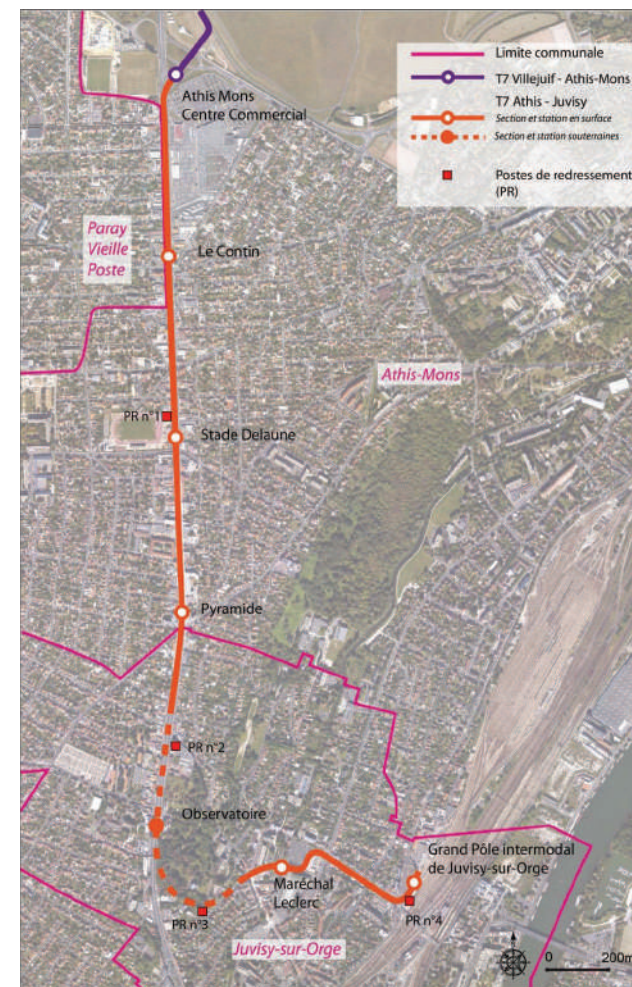
22 - Localisation des postes de redressement
