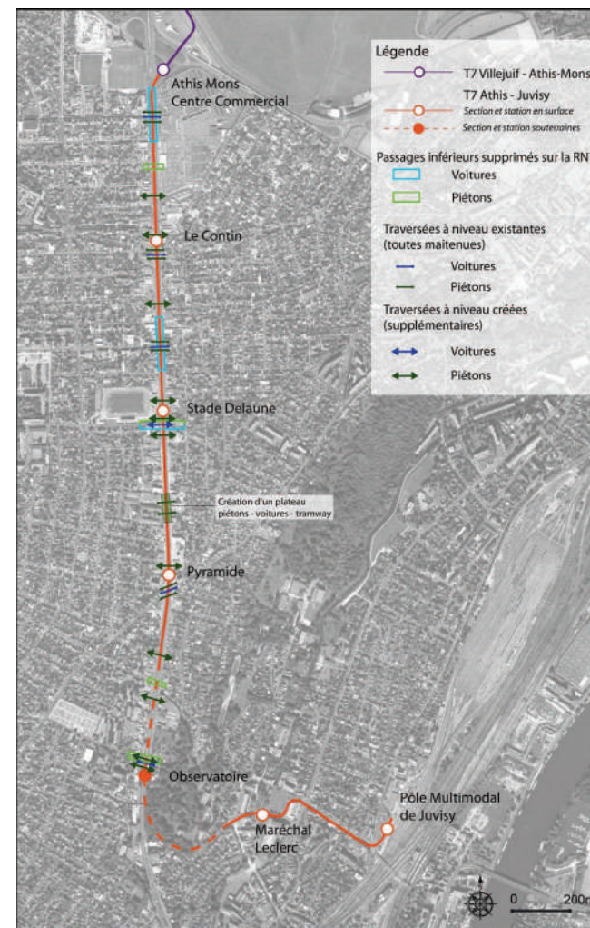
77 - Traversées à niveau créées sur la RN7
