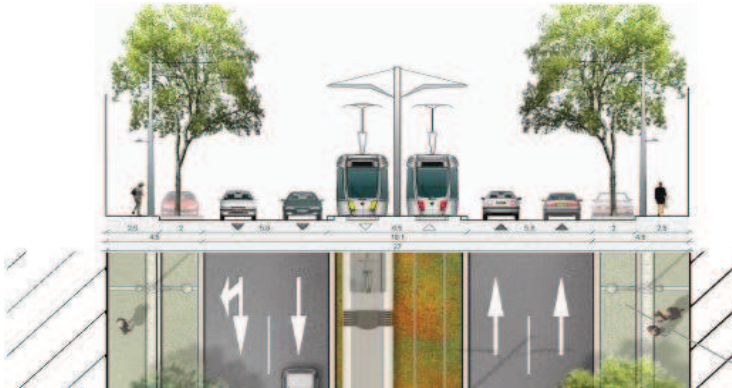
27 – Profil en travers en section courante sur la RN7 (section à 27 m)
