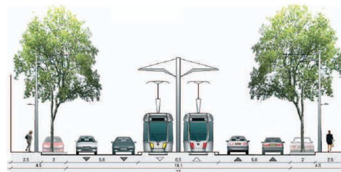
Figure 3 - Coupe type de la RN7 entre les stations « Athis-Mons Centre commercial » et « Pyramide »
