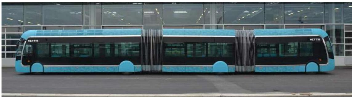
Figure 1 : Exemple de véhicule biarticulé de 24 m (Mettis de Metz)
