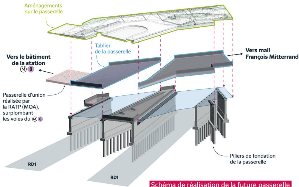
Schéma de réalisation de la future passerelle
