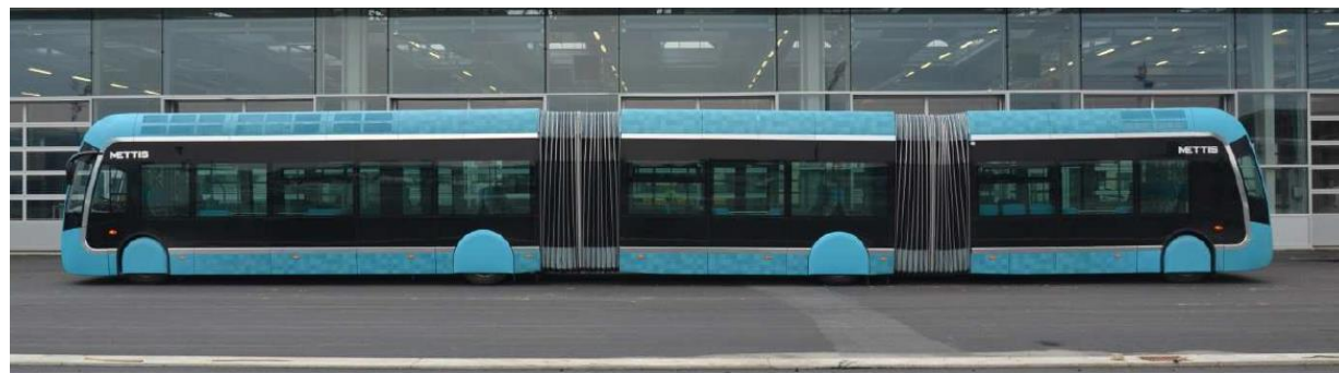
Figure 92 : Exemple de véhicule biarticulé de 24 m (Mettis de Metz)
