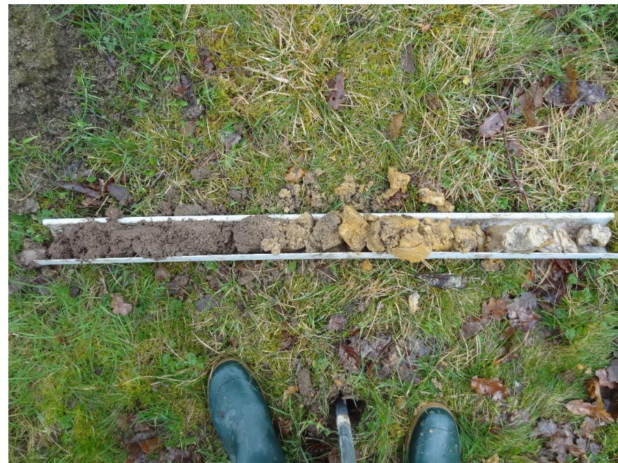
Figure 152 : Sondage avec 3 horizons visibles et distincts (non humide en noir, rédoxique et orange et réductique en gris) ©B. Desille (Egis, 2020)
