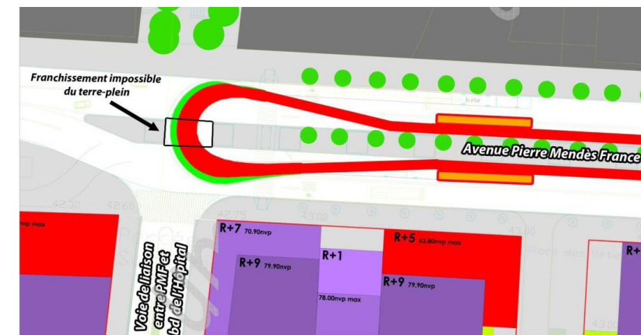
Figure 94 : Variante de terminus nord Gare d'Austerlitz Source : Etudes de DOCP, Ile-de-France Mobilités, Mars 2013
