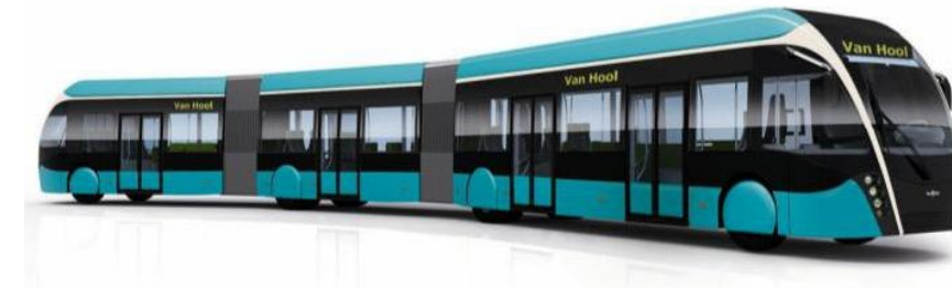
Figure 61 : Matériel roulant biarticulé Source : AVP Ozen, IDFM, 2020
