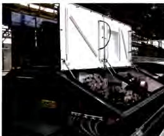
Coffre Pont Onduleur (PO) déporté en toiture
