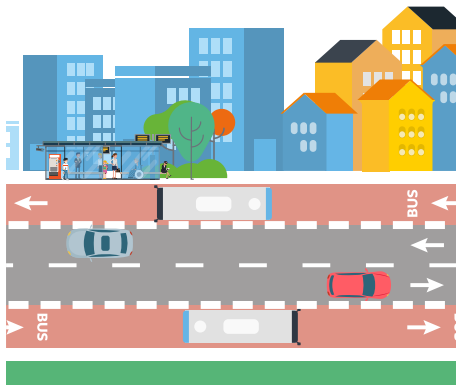
Figure 2 : Couloirs bus latéraux unidirectionnels dans chaque sens de la circulation générale
