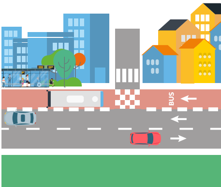
Figure 1 : Couloir bus latéral unidirectionnel dans le sens de la circulation générale
